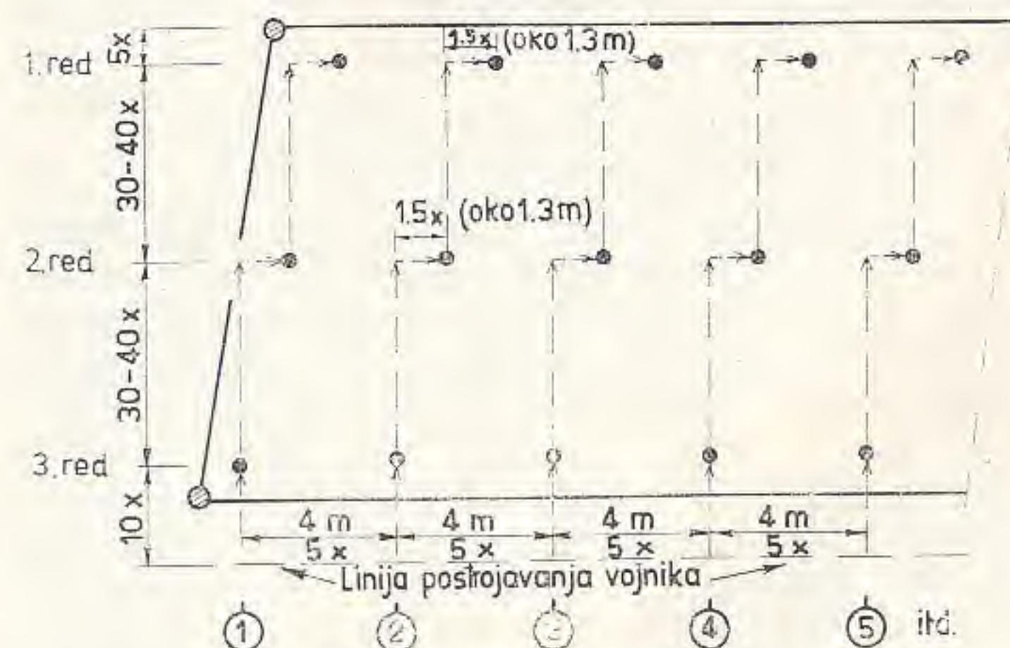
Sl. 15 — *Način raspoređivanja protivtenkovskih mina stroyevim rasporedom u minskom polju gustine 0,75 mina/metar — prvi način*
